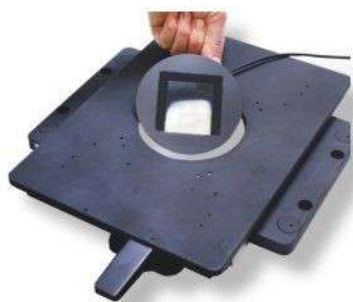
Нагревательная система для оригинального столика инвертированного микроскопа, включая установку
