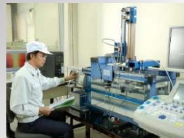
Автоматическое тестирование акустических характеристик датчиков
